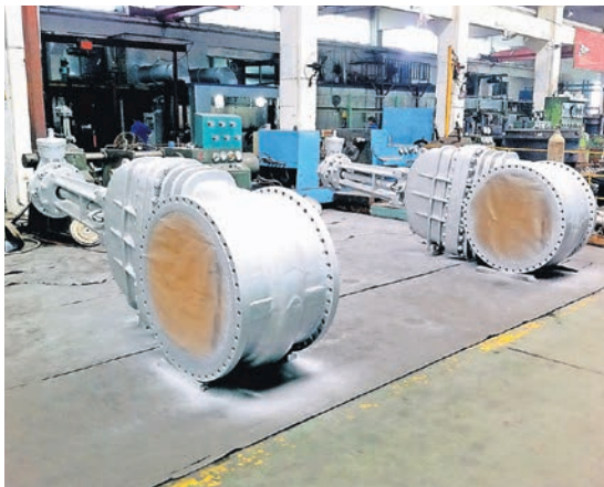
Absperrschieber der Nennweite DN 600 für einen Chemiekopf in Deutschland
