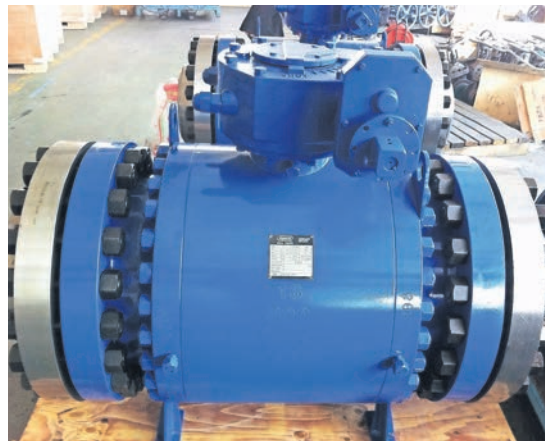
Kugelhahn der Nennweite DN 400 für einen Kunden in Saudi Arabien
